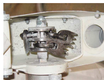
乾式除去装置(内部)
