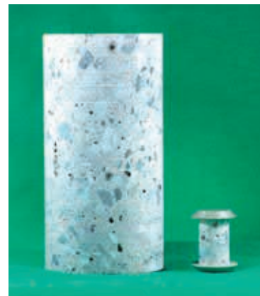
左:標準コア(直径10cm) 右:小径コア(直径2cm)
