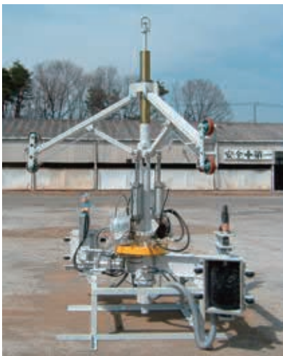
煙突除染装置
