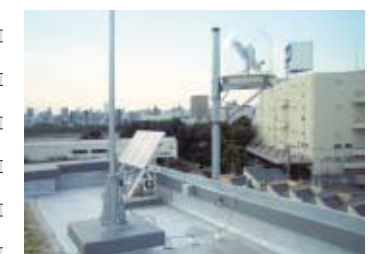
追跡装置の電源用ソーラーパネルと集光装置
