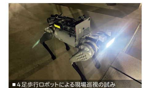
■ 4足歩行ロボットによる現場巡視の試み
