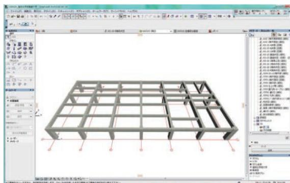
図-8 柱・梁配置済 3Dモデル画面
