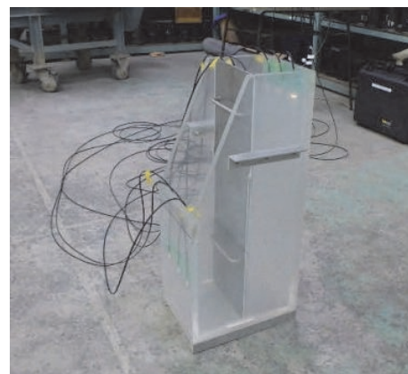
写真-6 実験用型枠
