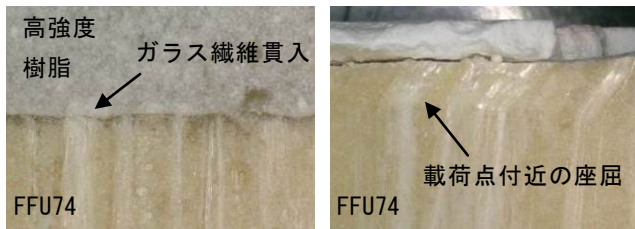
写真-6 破壊部の拡大写真
