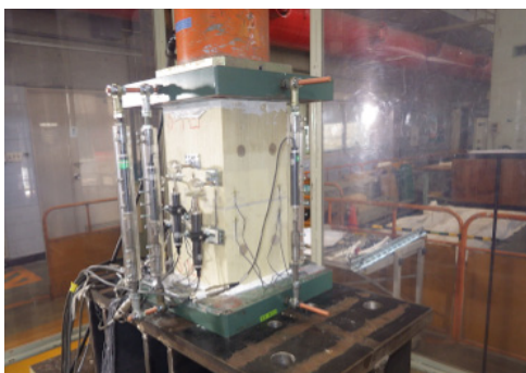
写真-5 実大モデルの圧縮試験状況
