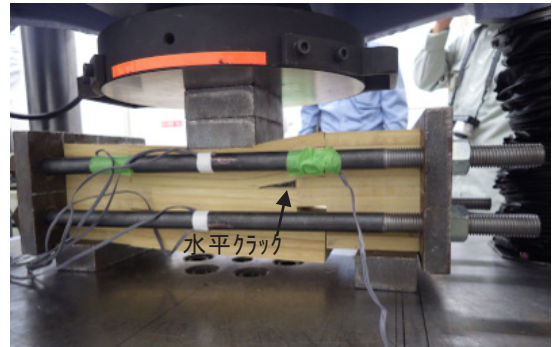
写真-1 縮小モデルでのせん断試験状況 (No. 6)
