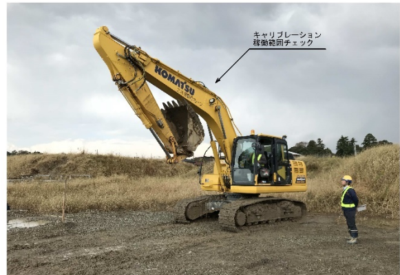
写真-1 ICT 建機のキャリブレーション
